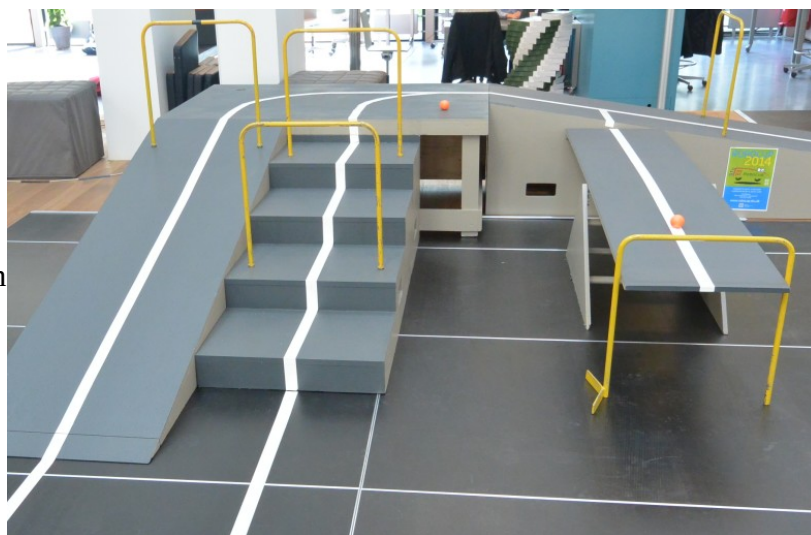
Figur 4: Rampe, plateau, trappe og vippe. De orange golfkugler på plateauet og vippe er netop synlige. Gulvet er sorte felter med smalle aluminiumskanter.
