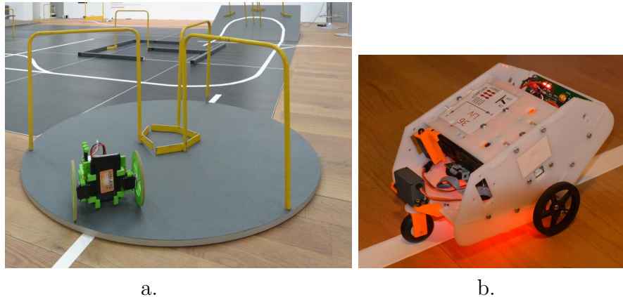
Figur 5: Treporten (a.) med 3 porte på et (ca. 25 mm) hævet plateau. (b.) Den autonome vagtrobot der beskytter treporten.
